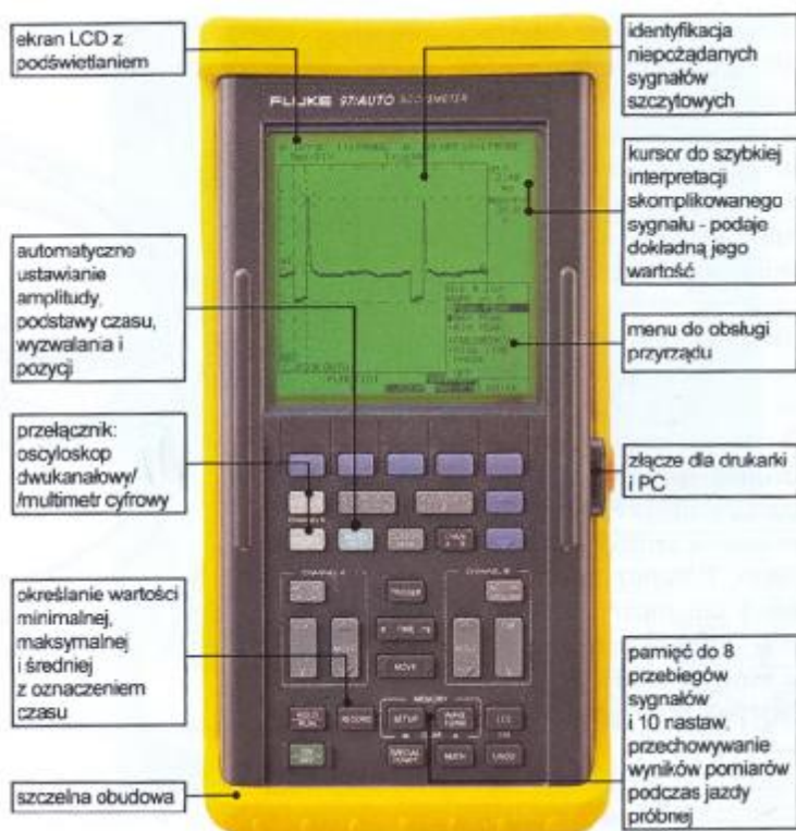
Rys. 11. Uniwersalne mierniki – multimetry a) uniwersalny miernik pomiarowy, b) uniwersalny miernik pomiarowy z oscyloskopem [7, s. 20, 23]
