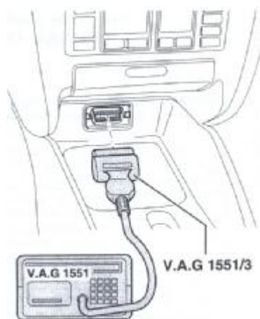
Rys. 10. Miejsce podłączenia testera V.A.G. w pojeździe [2, s. 75]
