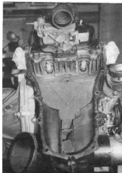
Rys. 13. Silnik czterosuwowy chłodzony powietrzem bez górnej osłony wentylatora układu chłodzenia [1, s. 14].
