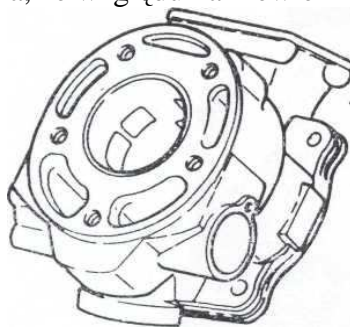
Rys. 6. Chłodzony cieczą cylinder silnika Yamaha RD 125 LC [1, s. 15].
