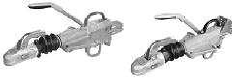
Rys. 43. Zaczepy przyczep lekkich z hamulcami najazdowymi [11].
