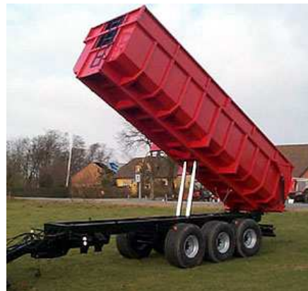
Rys. 44. Przykłady przyczep: a) dwuosiowa z centralnymi osiami, b) samowyladowcza trzyosiowa [9].
