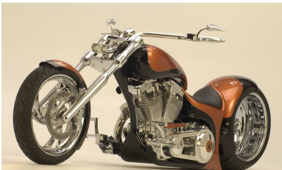
Rys. 63. Chopper z wydłużonym przednim zawieszeniem [9].
