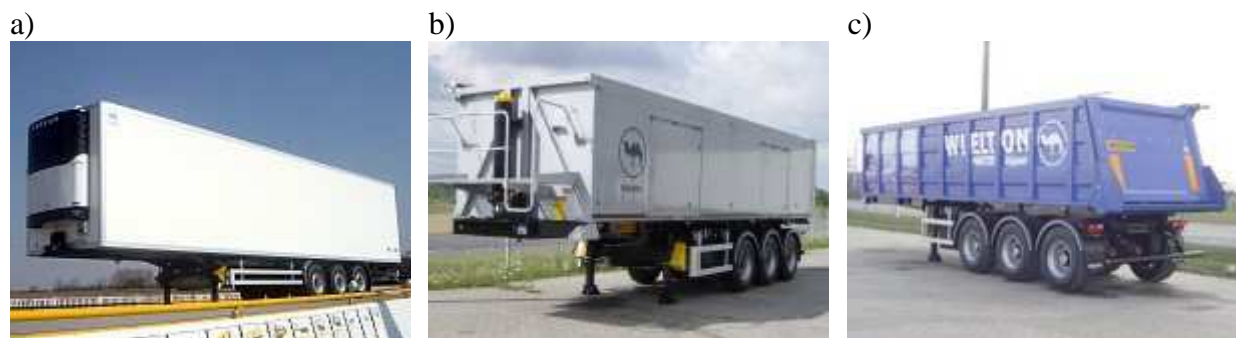
Rys. 53. Naczepy: a) chłodnia, b) wywrotka, c) wywrotka stalowa [14].
