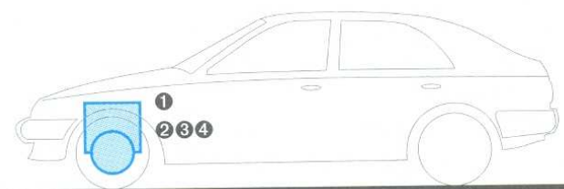
Rys. 12. Napęd zablokowany przedni: 1) silnik, 2) sprzęgło, 3) skrzynia biegów, 4) most napędowy [3, s. 160].
