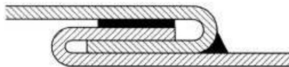
Rys. 35. Kształtowe łączenie blach połączone z lutowaniem [12],
