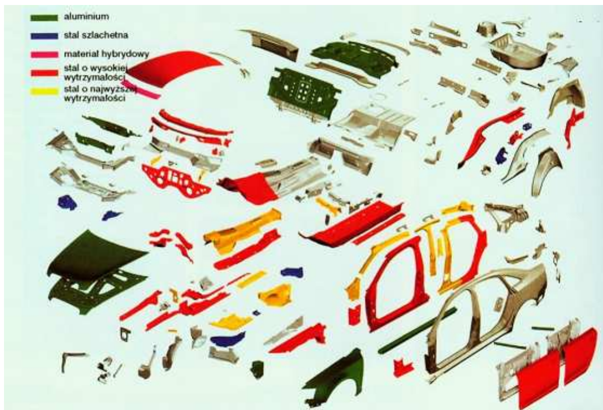
Rys. 1. Rodzaje materiałów metalowych stosowanych w budowie nadwozia samochodu osobowego [10, s. 30].
