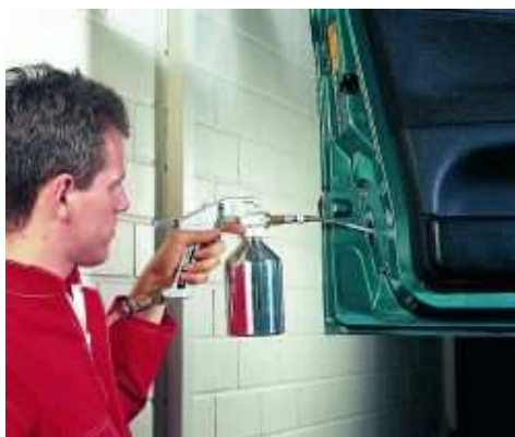
Rys. 21. Zabezpieczenie antykorozyjne przestrzeni drzwiowych [10, s. 10].
