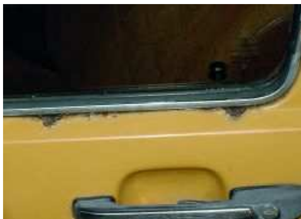
Rys. 20. Ogniska korozji na powierzchniach zewnętrznych [10, s. 12].
