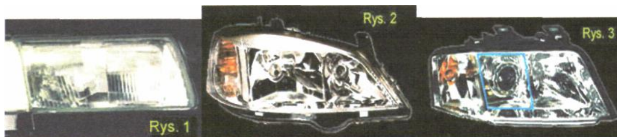
Rys. 8. 1- reflektor paraboliczny, 2 - reflektor całopowierzchniowy, 3 - reflektor z projektorem
