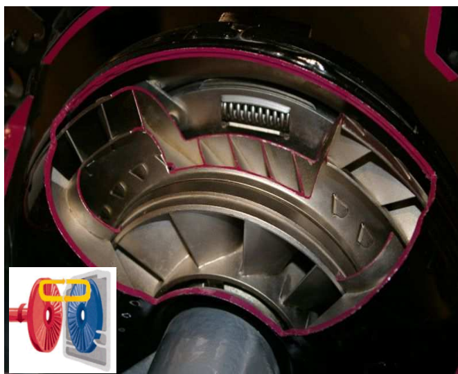
Rys. 28. Zwalniacz hydrokinetyczny (retarder) i jego zasada działania [9].
