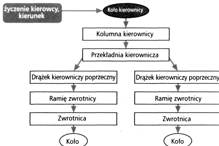
Rys. 1. Schemat funkcjonowania układu kierowniczego [1, s. 20].
