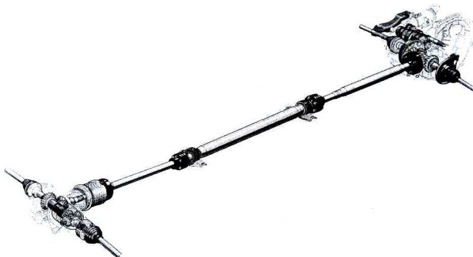
Rys. 35. Układ napędowy samochodu z napędem na wszystkie koła [1, s. 188].
