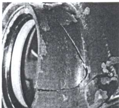
Rys. 58. Pęknięcia obudowy naprawia się dziś przeważnie metodą klejenia. Przyczynami (oprócz kolizji drogowych) są: niewyważenie części wirujących lub blokowanie przekładni przez ciała obce [3, s. 197].
