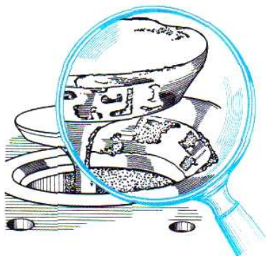
Rys. 48. Typowe ubytki materiału na przyłgniach zaworu i gniazda zaworu [5, s. 256].
