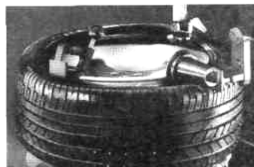
Współpraca rolki dociskowej z uchwytami blokującymi. U góry: faza wstępna. U dołu: faza końcowa
