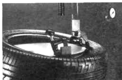
Początek nasuwania obrzeża na oponę
