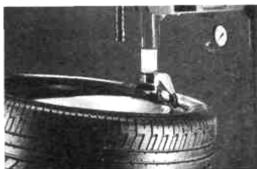
Początek nasuwania obrzeża na oponę
